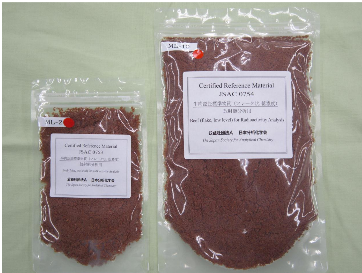
写真 開発した2種類の放射能分析用牛肉認証標準物質（フレーク状） （左；JSAC 0753、右；JSAC 0754、ポリエチレン袋にパックされ滅菌されている。）
