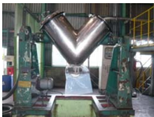
写真4 V型混合機 内容量 230L 回転速度 31rpm (実測値)
