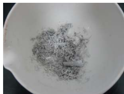
写真5 マッフル炉による灰化試料
