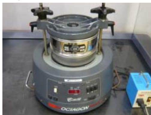
写真 3：電磁振動篩い分け器 使用条件：連続振動 5 分間 振動強度
