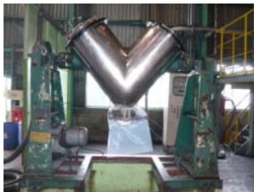
写真4：V型混合機 内容量 230 L 回転速度 31 rpm (実測値)
