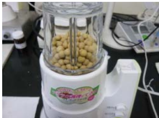
写真 2 フードミル 使用条件：連続粉砕 1 分間 試料投入量 約 75 g/回
