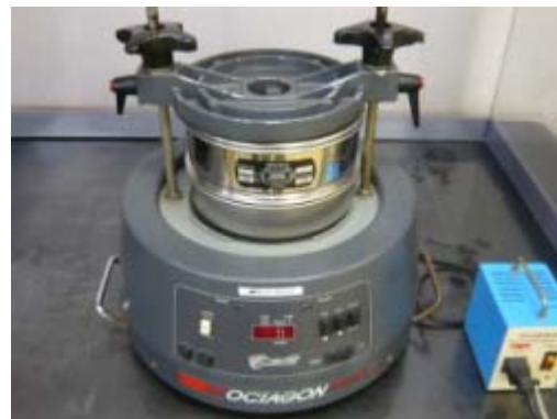
写真 3 電磁振動篩い分け器 使用条件：連続振動 5 分間 振動強度 8 試料投入量 約 300 g/回
