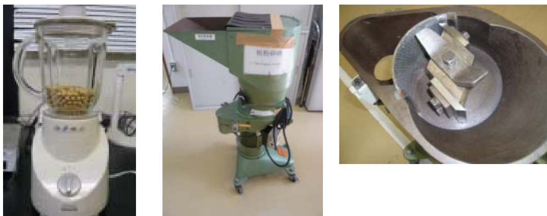
写真3：左:ミキサー、中: 堅型粉碎機（外観）、右: 堅型粉碎機（内部）
