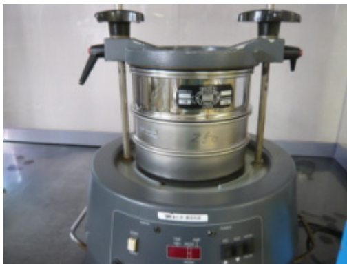
写真3：電磁振動篩い分け器 使用条件：連続振動5分間 振動強度8
