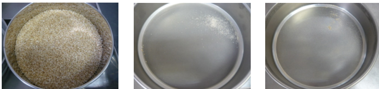
写真4：分級後（左:1mm 篩い目上、中:250 \mu m 目篩い上、右:受け皿）
