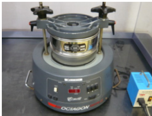
写真2：電磁振動篩い分け器 使用条件：連続振動 3 分間 振動強度 8 試料投入量 約 500g/回
