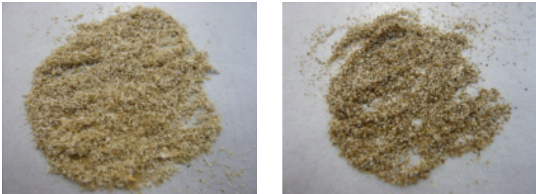
写真5：分級後試料（左：250 μ m～1mm 試料、右：250 μ m 未満試料）
