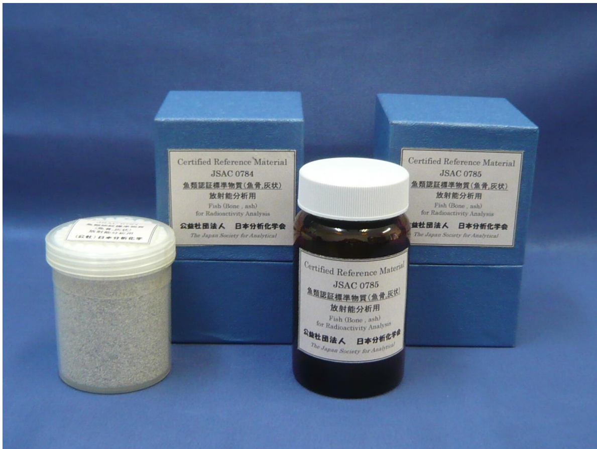
写真2 開発した放射能分析用魚類認証標準物質（魚骨、灰状）（JSAC 0784 及び JSAC 0785） 左（JSAC 0784）：ポリプロピレン製容器（U8）内に、高さが 50 mm になるように充てんされた標準物質と梱包の箱。容器上部にみられる白色部分は魚骨が移動しないための充てん剤です（内容量 97.0 g）。右（JSAC 0785）：ガラス製 100 mL 容器に充てんされた標準物質と梱包の箱。内容量 70 g。
