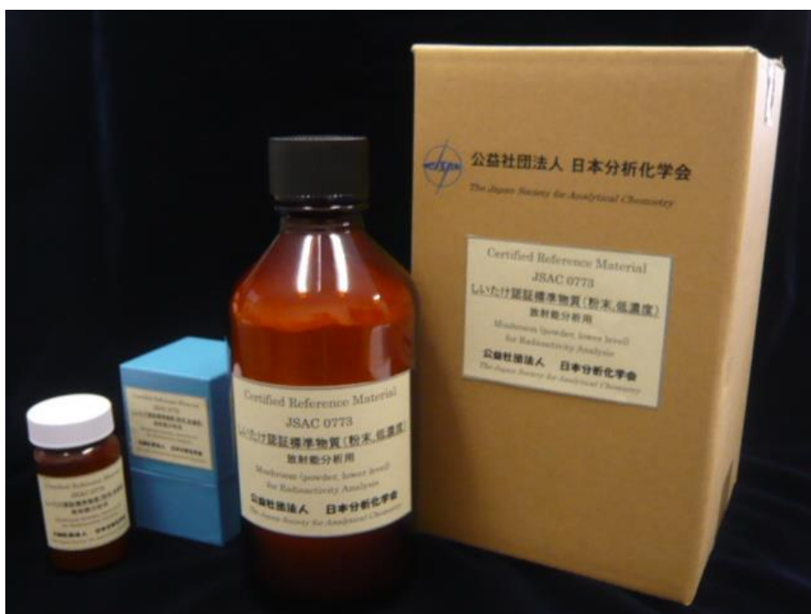
写真2 開発した放射能分析用しいたけ認証標準物質（粉末状、低濃度）（JSAC 0772 及び JSAC 0773）ガラス製容器に充てんされた標準物質と梱包の箱。左（JSAC 0772）；100 mL 容器、内容量 約 30 g、右（JSAC 0773）；1 L 容器、内容量 約 300 g。
