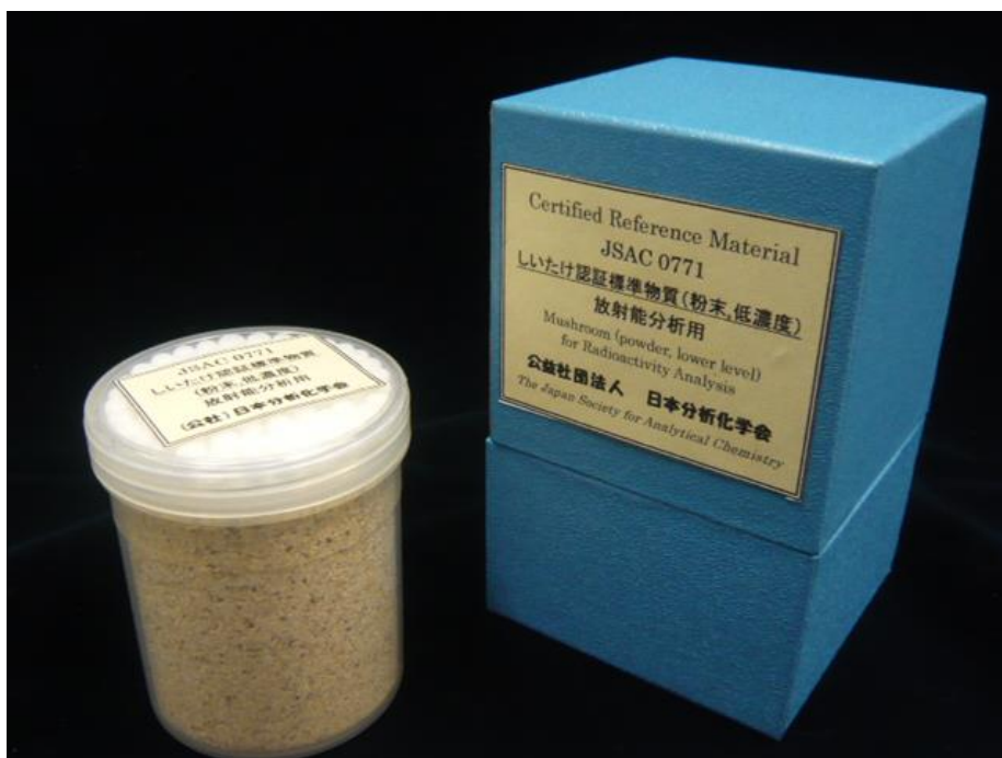
写真1 開発した放射能分析用しいたけ認証標準物質（粉末状、低濃度）（JSAC 0771）ポリプロピレン製容器（U8）内に、高さが 50 mm になるように充てんされた標準物質と、梱包の箱。容器上部にみられる白色部分はしいたけが移動しないための充てん剤です（内容量 30.0 g）。
