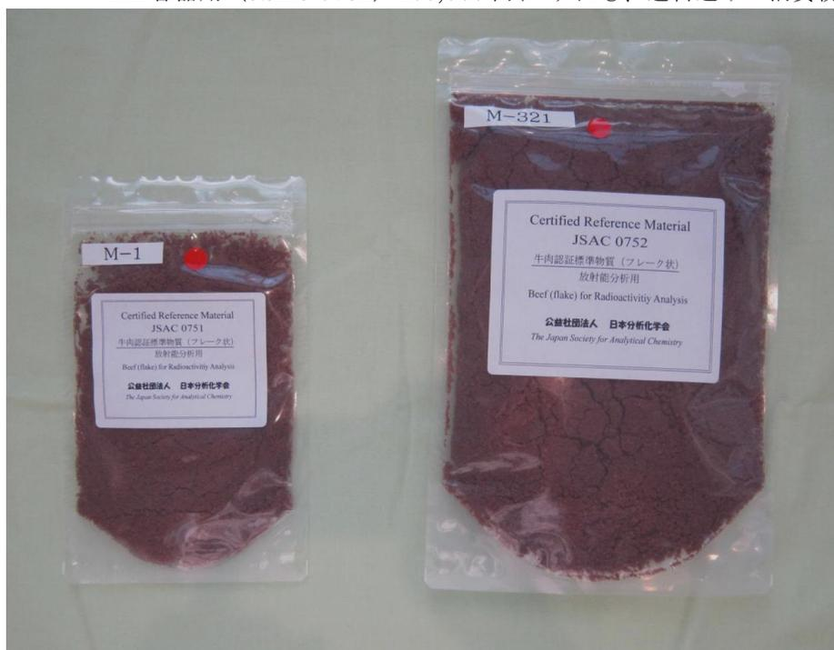
写真 開発した2種類の放射能分析用牛肉認証標準物質(フレーク状)
