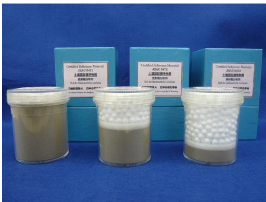
写真 開発した3種の放射能分析用土壤認証標準物質（JSAC 0471, JSAC 0472, JSAC 0473） 同一種均質土壤をプラスチック製容器（U8）の高さ 50 mm, 30 mm, 10 mm に充填された土壤 認証標準物質。容器上部にみられる白色部分および白球は土壤が移動しないための充てん 剤である。
