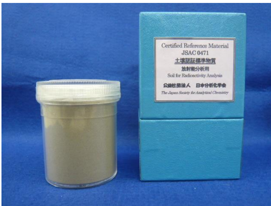
写真 開発した放射能分析用土壤認証標準物質（JSAC 0471） プラスチック製容器（U8）の高さ 50 mm に充填された土壤認証標準物質。 容器上部にみられる白色部分は土壤が移動しないための充てん剤である。
